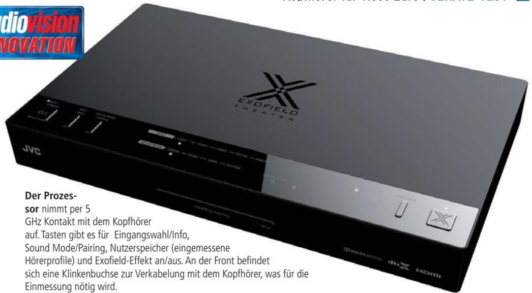
**Der Prozessor** nimmt per 5 GHz Kontakt mit dem Kopfhörer auf. Tasten gibt es für Eingangswahl/Info, Sound Mode/Pairing, Nutzerspeicher (eingemessene Hörerprofile) und Exofield-Effekt an/aus. An der Front befindet sich eine Klinkenbuche zur Verkabelung mit dem Kopfhörer, was für die Einmessung nötig wird.
