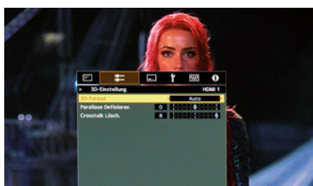
Helle 3D-Bilder: Wird der „Crosstalk Löscher.“ von 0 auf 8 gestellt, erhöht sich die Lichtausbeute hinter der 3D-Brille deutlich, ohne dass es zu Geisterbildern kommt.
