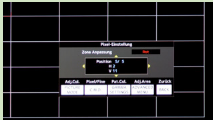
Pixel-Einstellung: In über 100 Zonen kann die Konvergenz mit Rot oder Blau fein angepasst werden. Grün gilt hier als „Referenz“ für den Abgleich.
