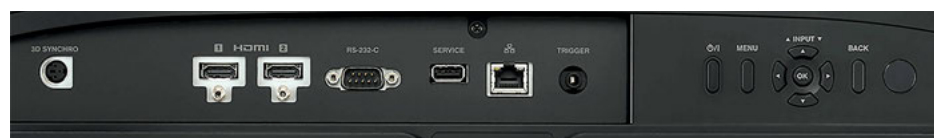
Alle Anschlüsse befinden sich auf der Rückseite des Projektors. Die beiden HDMI-2.1-Schnittstellen mit 48 Gbps und HDCP 2.3 übertragen Signale bis zu 4K/120 Hz und 8/60 Hz. Rechts daneben befindet sich ein Bedienfeld, falls die Fernbedienung mal nicht zur Hand sein sollte.
