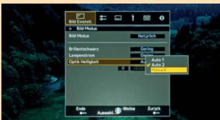
**Automatische oder manuell Blende:** In den Stufen „Auto 1“ und „Auto 2“ steuert der JVC die Iris automatisch. Alternativ lässt sich die Blende manuell fixieren.
