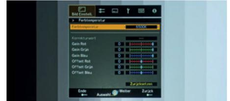
**Feines Bildwerkzeug:** Tüftler können alle Details nachjustieren, hier die RGB-Gain- sowie Offset-Werte. Zudem eignet sich der DLA-X5500 für eine Calman-Einmessung.
